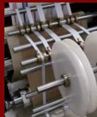
使用するリボン素材の幅に合わせて調整が可能な搬送用ガイドを採用。左右に振れる事なく安定した素材の搬送が可能です。
